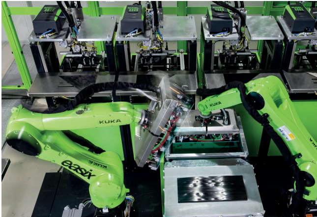
Bild 1. Das CAD-basierte Tapelegen vereinfacht den Aufbau von Stacks aus UD-Tapes. Die neue Technologie wird bereits für die Entwicklung und Herstellung innovativer Composite-Erzeugnisse eingesetzt. © Engel
